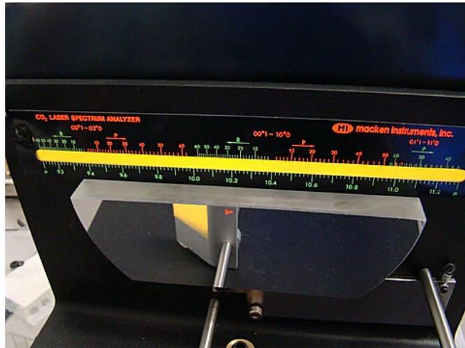
上图为16A的数据显示标尺, 上面的刻度是CO<sub>2</sub>转动谱线标记, 下面的刻度是以微米为单位的波长。中间是热敏屏幕, 工作时该屏幕以黑线显示激光波长。光谱分析屏幕的宽灵敏度范围可以同时显示功率密度相差20倍的激光产生的黑线。
