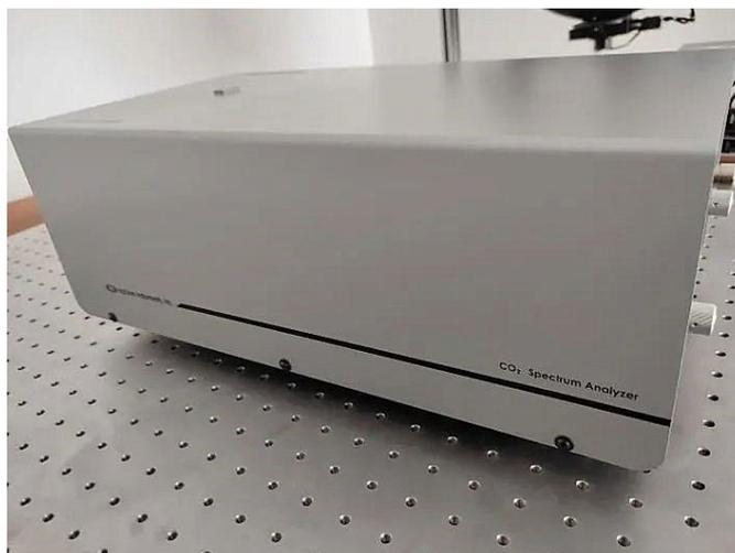
Macken公司生产研制的16A CO<sub>2</sub> 激光光谱分析仪采用的光栅分光镜能同时显示CO<sub>2</sub>激光所有的激光跃迁信息。它对波长和转动谱线的标记都进行了校准，能轻松识别9.1和11.3 $\mu$ m之间的140个激光跃迁信息。当红外激光光束撞击在UV(紫外)激发的热敏屏幕上会使屏幕局域变黑，从而将这些跃迁信息在视觉上显示出来。该产品分析显示屏(热敏屏幕)的响应时间为1/4秒，能够快速解析CO<sub>2</sub>激光器所有的转动谱线。(CO<sub>2</sub>激光是利用分子转动能级间的跃迁产生转动光谱，谱线丰富，在10 $\mu$ m附近就具有几十条谱线输出。)
