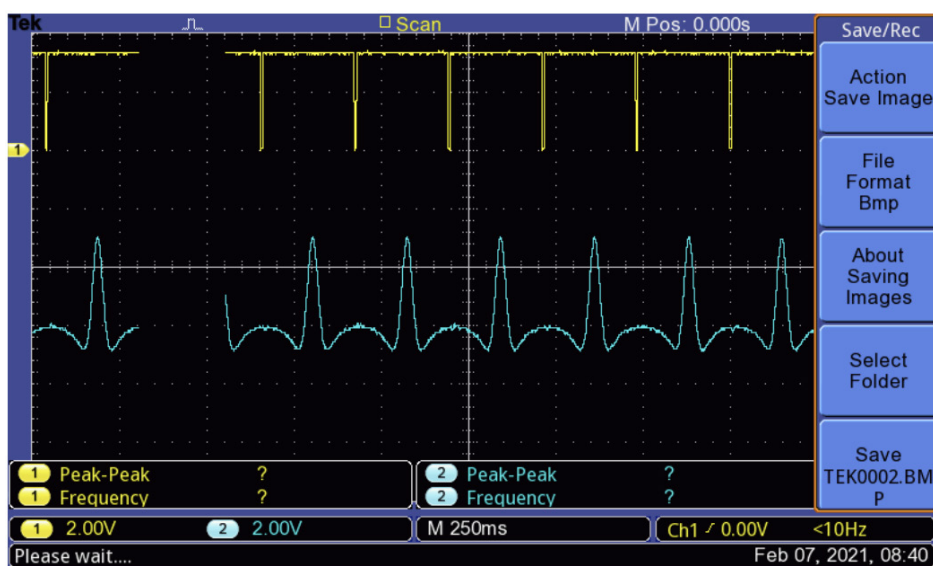
2004nm DFB激光器测量CO 2 气体吸收浓度幅值
