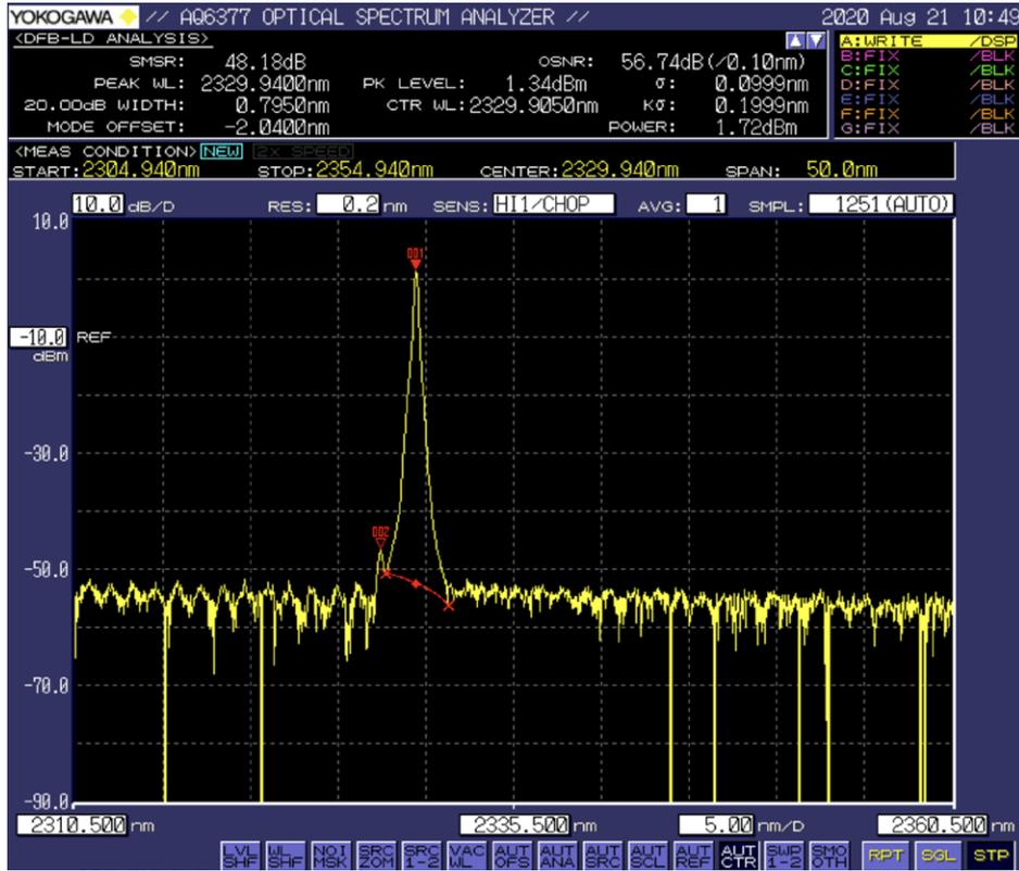
(图2 光谱仪上显示的DFB激光器 2330nm)
