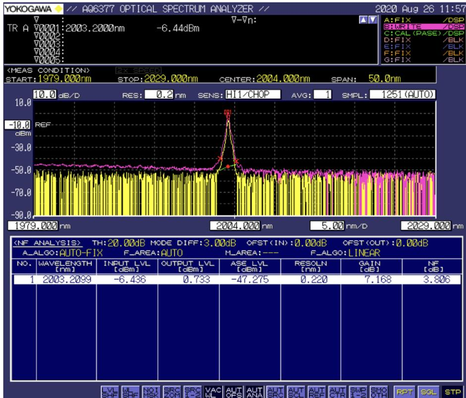
(图4 2004nm激光器，放大器光谱对比测试图)
